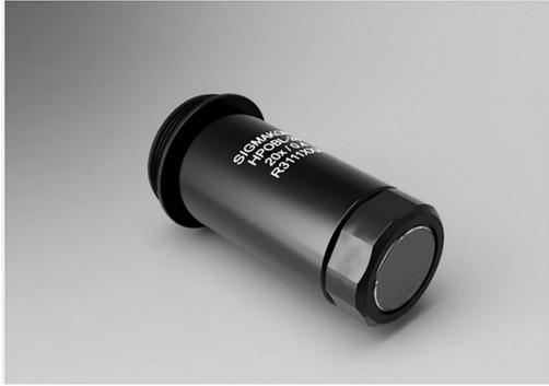
齐焦距离为45mm，镜片间不使用光学胶胶合而是空气隙的物镜。使用了紫外波段透过率较高的合成石英，以及紫外应用光学材料氟化钙（CaF<sub>2</sub>）。适用于大功率激光的聚焦或准直。
